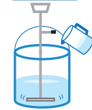
練混ぜ水の計量
