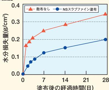
試験方法：ASTM C156に準ずる
